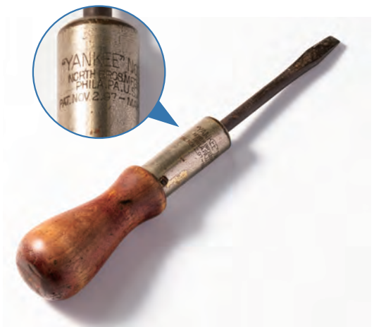
海外製高級工具などを扱っていた時代の商品。特許表示のあるアメリカ製のラチェットドライバー
