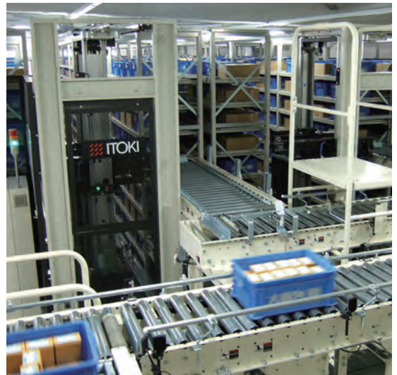
縦に回転して製品を収納することで空間を有効に活用できるロータリーストッカー。効率アップのため、2階まで6メートルの吹き抜け空間に設置しています
