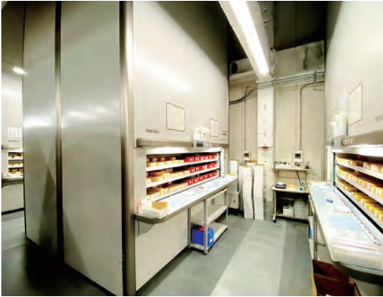
縦に回転して製品を収納することで空間を有効に活用できるロータリーストッカー。効率アップのため、2階まで6メートルの吹き抜け空間に設置しています
